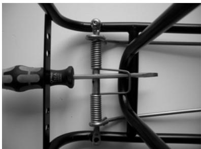
3. Feder mit einem stabilen (!) Schraubendreher vorspannen. Achtung: Schraubendreher weit genug einschieben, sonst Quetschgefahr der Finger !
