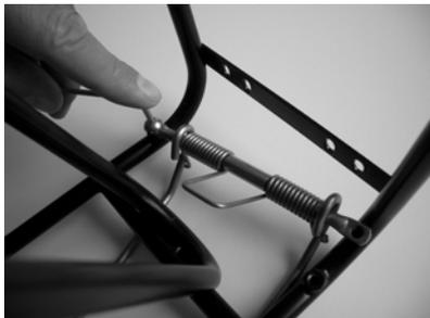
2. Federklappe mit einer der beiden Schrauben auf der Unterseite der Ladefläche befestigen.
