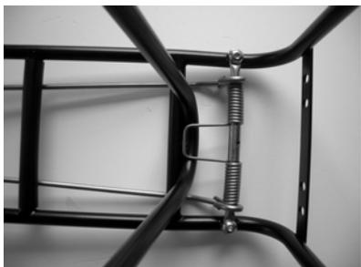
4. Federklappe mit zweiter Schraube befestigen Und beide Schrauben festziehen.
