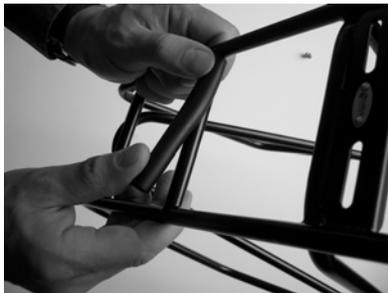
1. Plastikrohr auf Mittelstrebe aufstecken.
